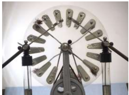
写真 1 ウイムズハースト起電機 旧制姫路高等学校物理実験機器 コレクションより (神戸大学所蔵)
