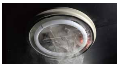
LEDランプが発煙・発火(再現実験)
