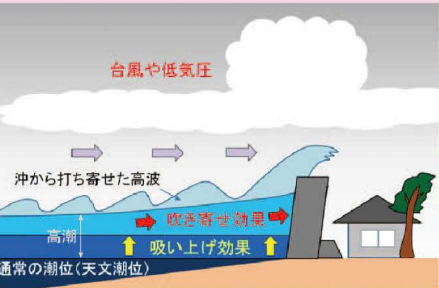
台風の時などは短時間のうちに急激に潮位が上昇し、海水が海岸堤防等を越えると一気に浸水します。
