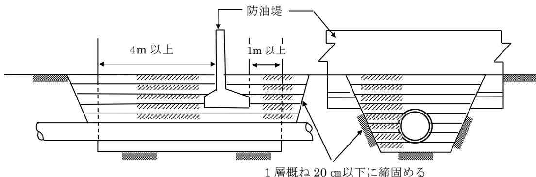
例図5 遮水壁の設置
