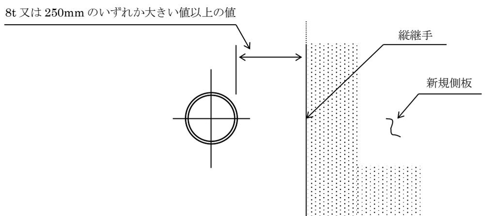
補強板なし小径ノズル
