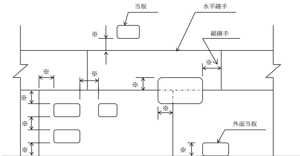
注1：溶接線相互間の最小値（溶接線止端間距離※）は50mm又は当板の厚さの8倍のいずれか大きい値とする。
