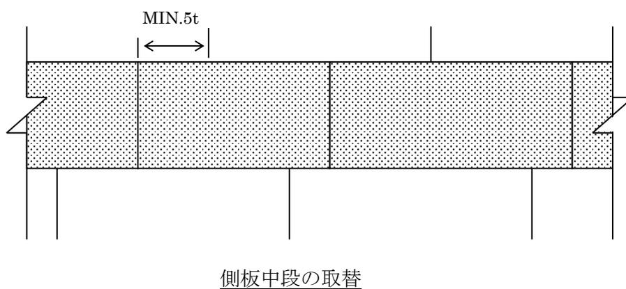
注：~~~~印の切り欠き部は最後に溶接する。tは側板の板厚を示す。(単位：mm)
