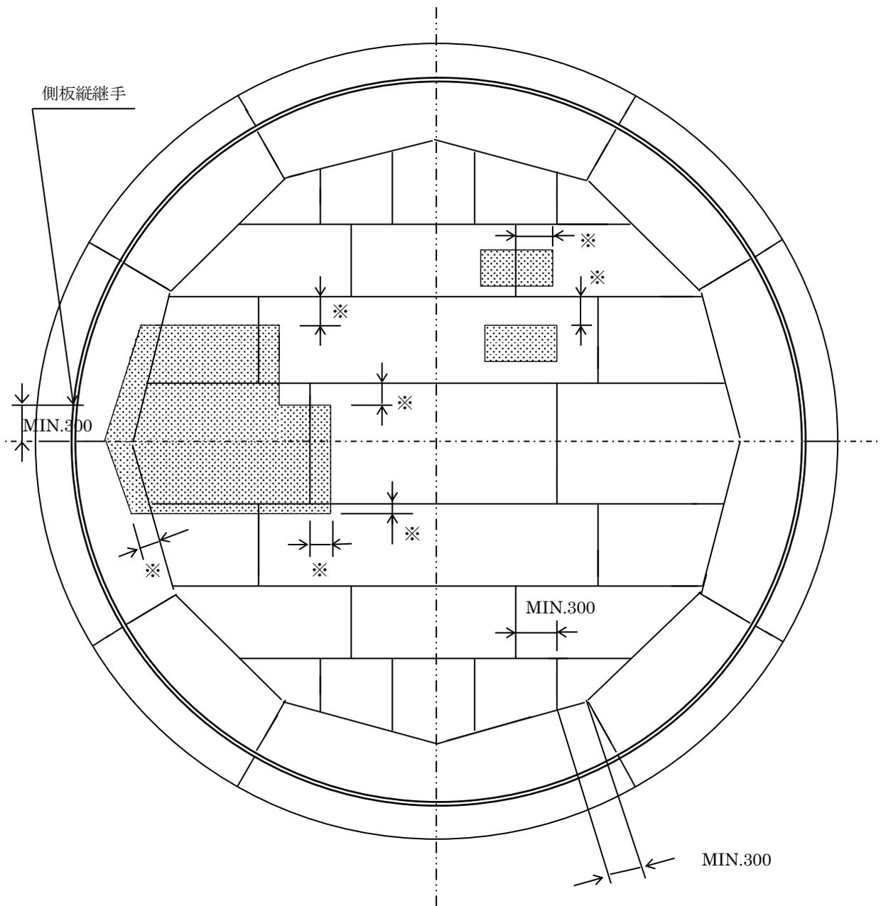
注1：※印寸法は底部の板の板厚の5倍以上とする。
