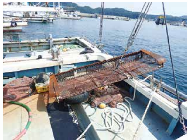
図4. 底曳き網の口につけるマンガと呼ばれる金具
