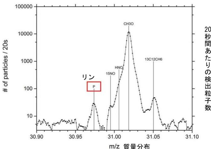
図 4 ロゼッタ搭載質量分析計のデータ (リンの場合) © ESA, 2016 翻訳分を加筆
