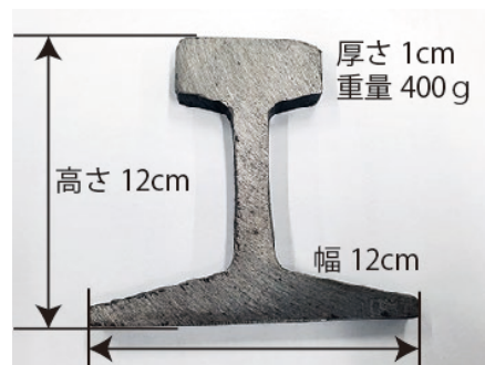
写真1 レールの断面 (40kg レール)
