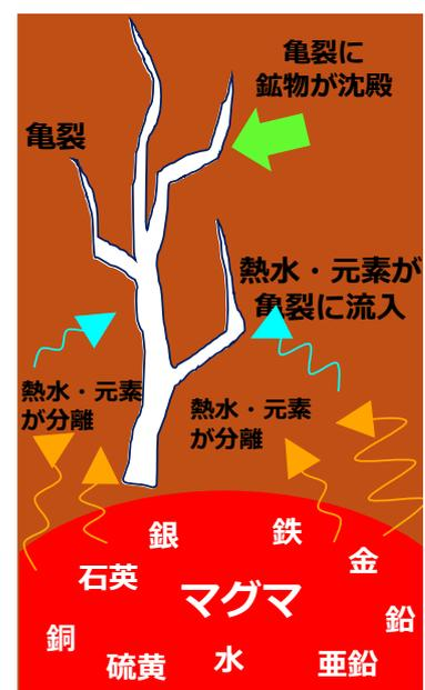
図1 熱水鉱床の形成過程
