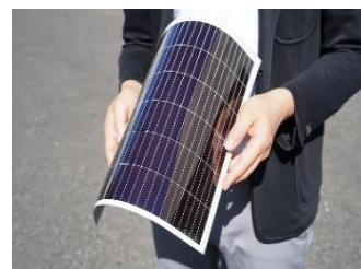
図1 リコーのインクジェット印刷で作製したペロブスカイト太陽電池 a
