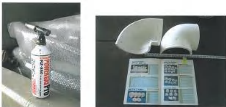
図6 着火源となったトーチ及び保温材（写真）
