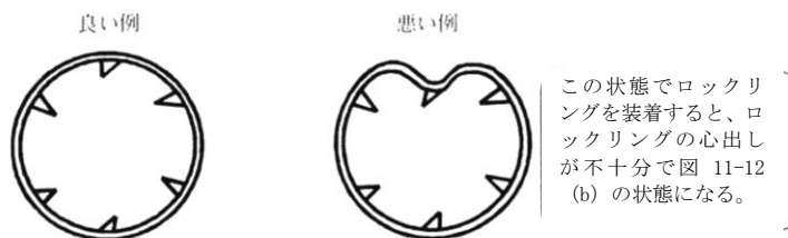
図 11-14 ロックリングの心出し用ゴムのセット
