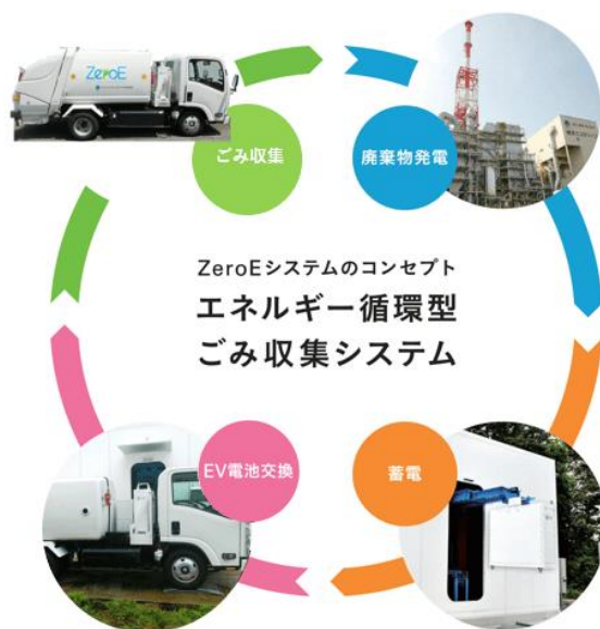
出典：JFE エンジニアリング株式会社 HP 図4-2 システムの流れ
