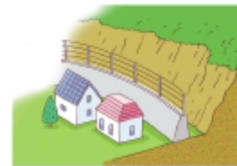
④土砂等を堆積するための施設
