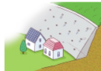
②土留の擁壁
