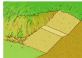
①法面の傾斜を緩くする
