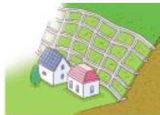
③法面を保護する法枠工
