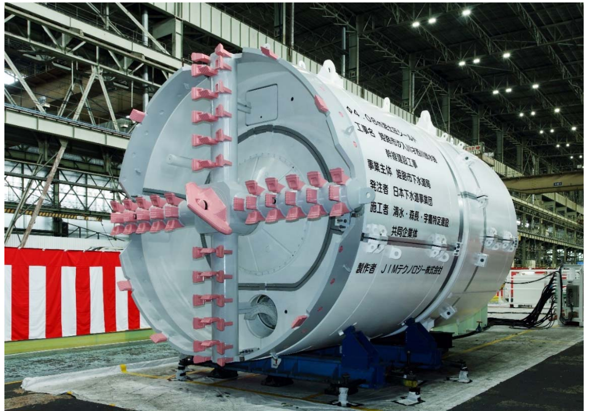
泥土圧式シールドマシン 外径4.08m 全長6.9m 総重量102t 横浜の工場で作製され、9分割されて現場で組み立てました。しるまる姫をイメージしたカラーリングです。
