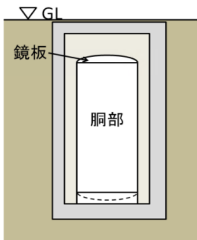
縦置円筒型のタンク室
