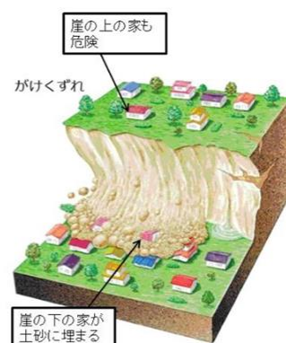
急傾斜地の崩壊
