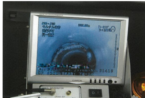
下水道管カメラ調査の状況
