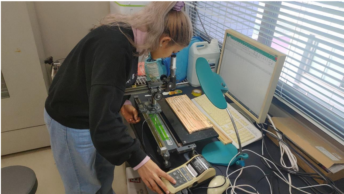
図 9 : 顕微鏡を用いた年輪試料の測定
