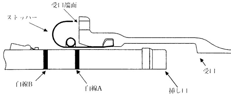
図11-70 挿し口の挿入
