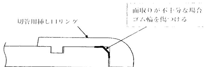
図 1 1 - 4 5 分割部（50mm幅）の断面図
