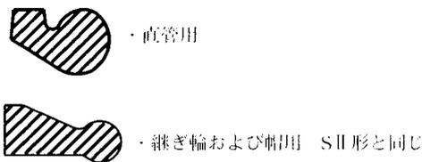
図 1 1 - 3 0 ゴム輪の断面形状
