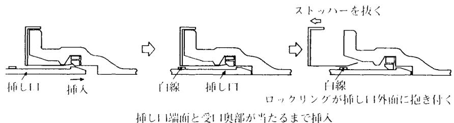
図 1 1 - 3 2 挿し口の挿入
