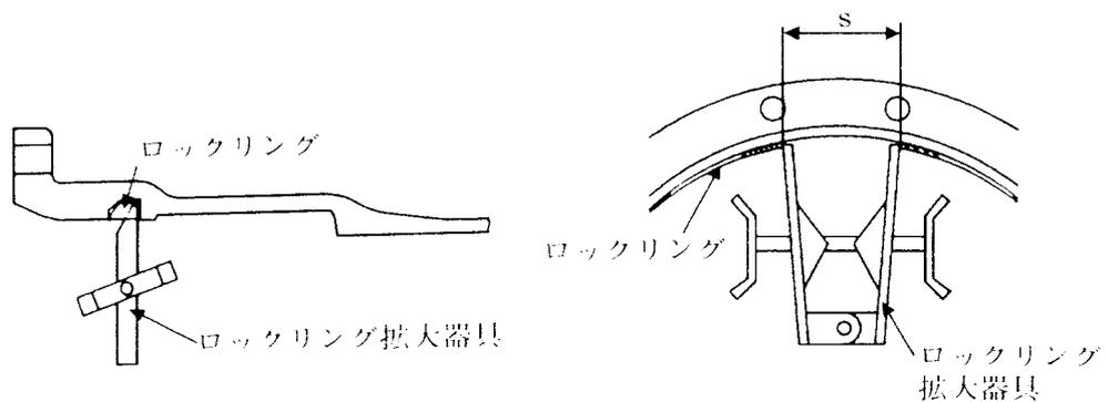
図11-65 ロックリング拡大器具の装着
