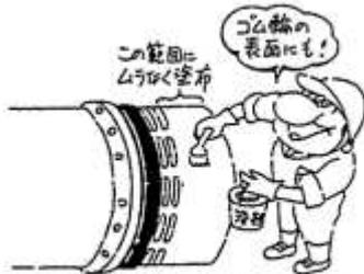
ハ 挿し口外面の端部から白線までの範囲にムラなく塗布する。
