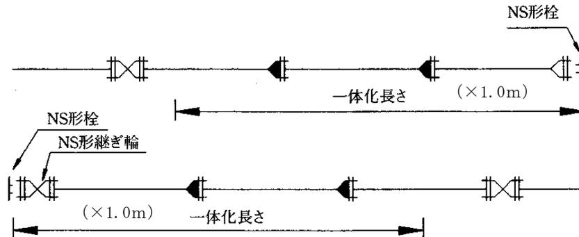
図 1 1 - 6 0 呼び径 500~1000 NS 形の管端部
