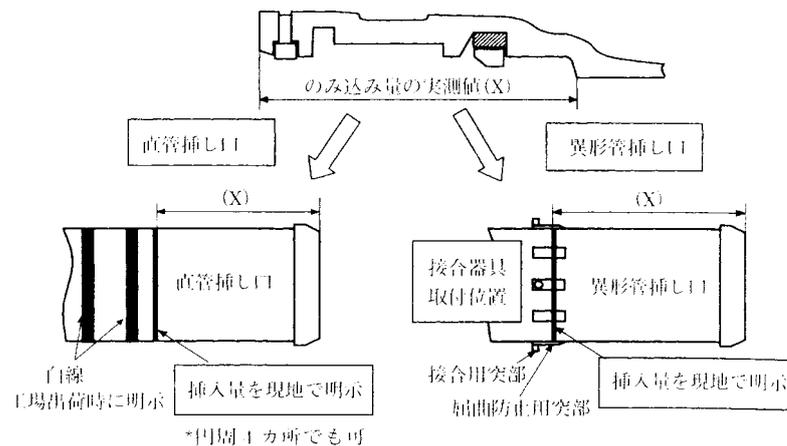
図 1 1 - 2 5 挿し口の挿入量
