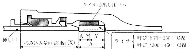
図 1 1 - 3 4 ライナ使用時の接合構造
