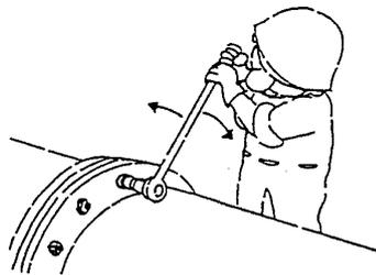
ホ 最後にトルクレンチによりニの手順で規定トルクまで締める。
