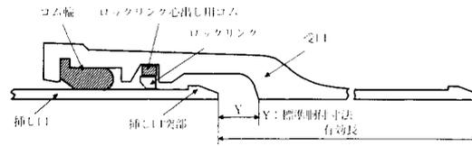
図 1 1 - 8 直管の継手構造
