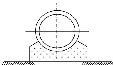
図 1 1 - 9 3 コンクリート受台基礎の例
