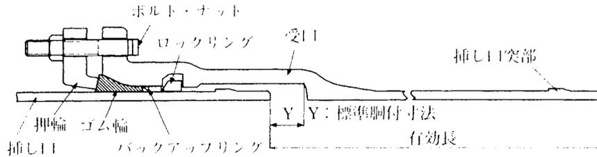
図 1 1 - 6 1 直管の継手構造
