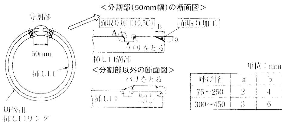
図 1 1 - 4 4 挿し口のバリ取りおよび面取り
