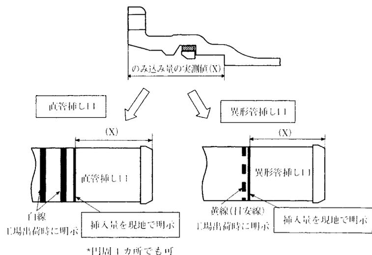
図 1 1 - 2 9 挿し口の挿入量 (x)
