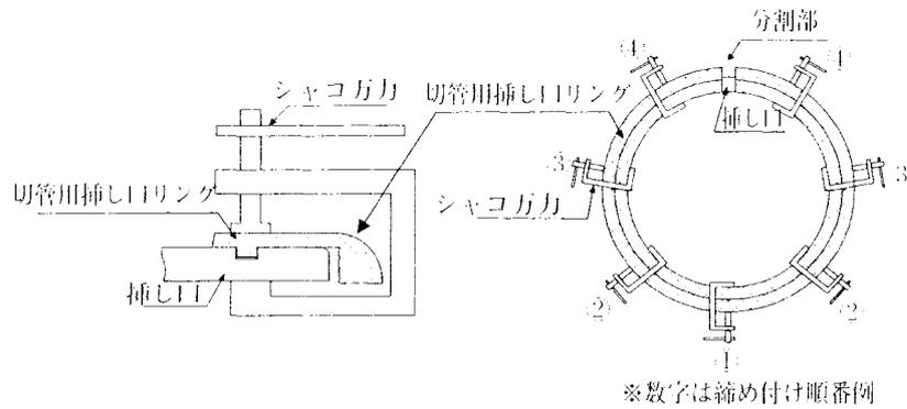
図 1 1 - 4 9 切管用挿し口リングの締め付け
