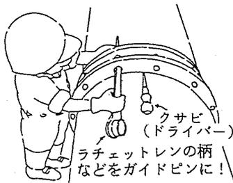
イ 管と押輪のボルト孔を合わせる(ラチェットレンチの柄などを利用してガイドピンとする)。
