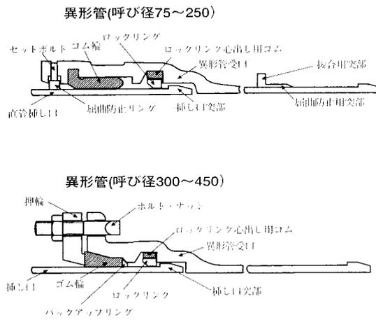
図 1 1 - 9 異形管の継手構造
