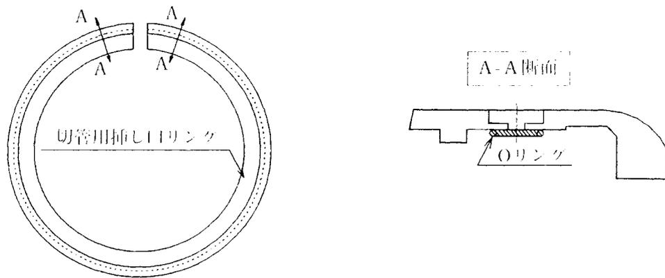
図 1 1 - 4 6 切管用挿し口リング
