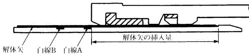
図11-56 正常に解体矢を挿入した状態
