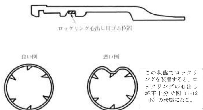
注) ロックリングを清掃し、絞り器でロックリングを絞って、図11-14に示す溝内のロックリング心出し用ゴムの上に正しくセットする。ロック
