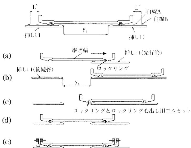
図 1 1 - 3 8 継ぎ輪の施工手順 (せめ配管の場合)
