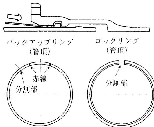
図11-71 バックアップリングの挿入
