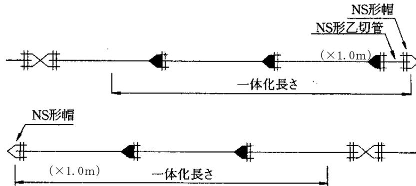
図 1 1 - 5 9 呼び径 75~450 NS 形の管端部
