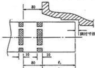
イ 受口(挿し口)に挿し口(受口)を挿入する。
