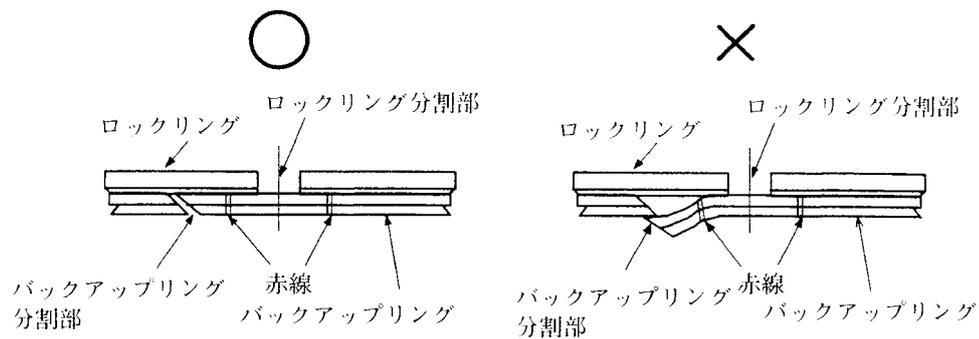
図 1 1 - 7 2 バックアップリング分割部の確認
