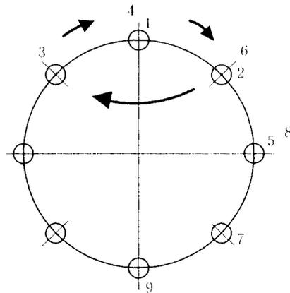
標準締め付けトルク(ボルトの呼びM 2 0)・・・100 N・m
