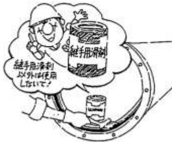
イ 滑剤は“ダクタイトル管継手用滑剤”（または固形石けんをナイフで削り、熱湯に溶かした濃い石けん液）を使用する。
