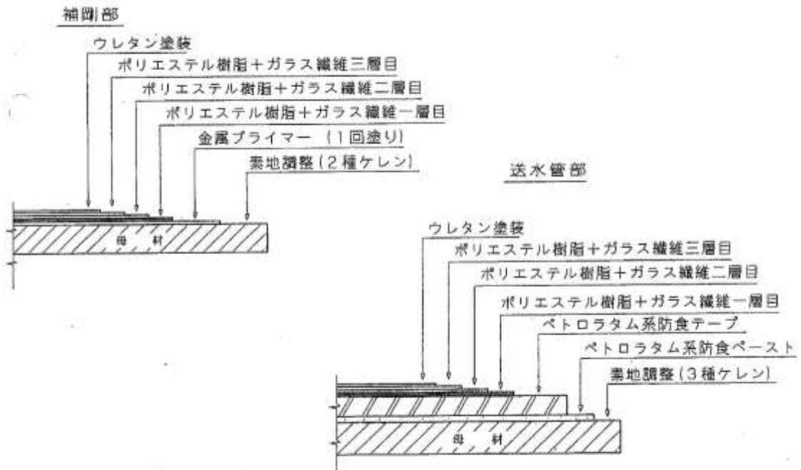
図 1 1—9 8 防食保護工標準図 (T 形補剛水管橋)
