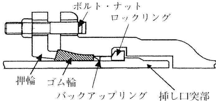
図 1 1 - 6 2 異形管の継手構造
