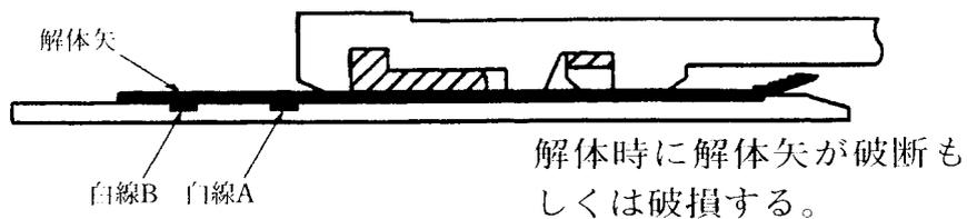
図 1 1 - 5 7 解体矢の挿入が異常な状態
