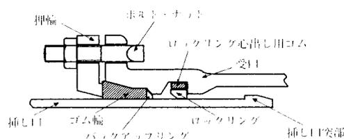
図 11-1-1 継ぎ輪・帽の継手構造
