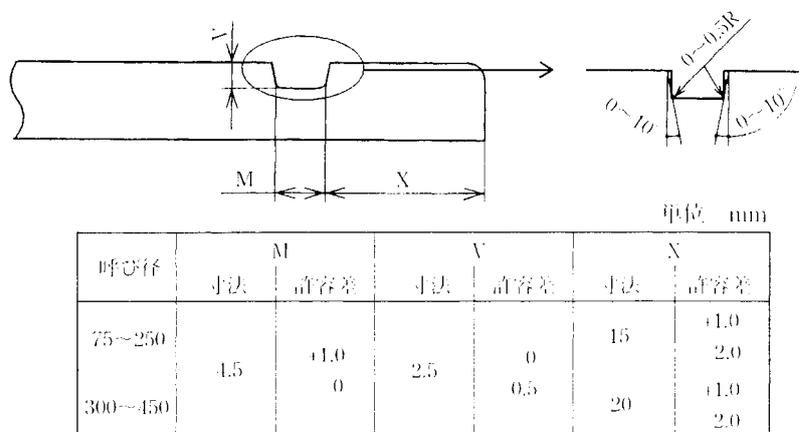
図1 1-4 1 挿し口加工寸法
