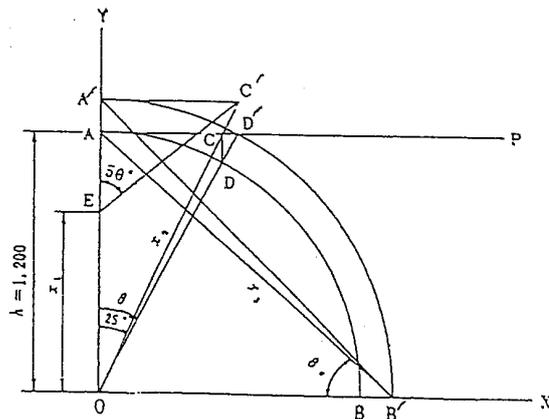
図11-91 ひねりベンドの図式解法
