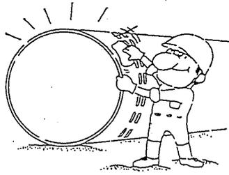
ハ 押輪の内外面、ボルト孔を清掃し、挿し口に預ける。
