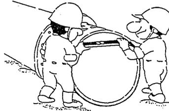
ロ 図11・80に示すようにゴム輪を挿し口に預け入れる。（挿し口の外面に滑剤を塗布しておくとも預け入れやすい）
