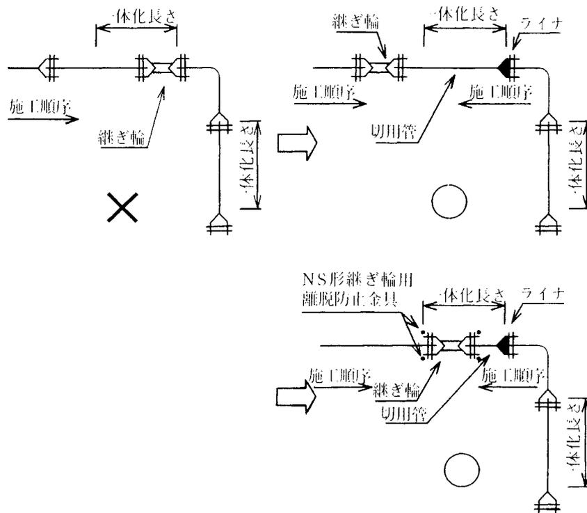
図 1 1 - 3 9 異形管周りでの継ぎ輪の設置方法
