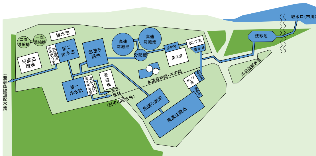
図表 2-3 既存施設（甲山浄水場）の平面図（イメージ）
