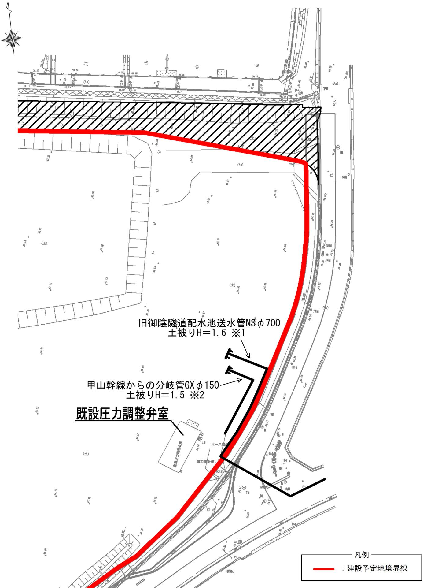
※1：NSφ700の端部は継輪栓撤去後、継輪に接続可能
