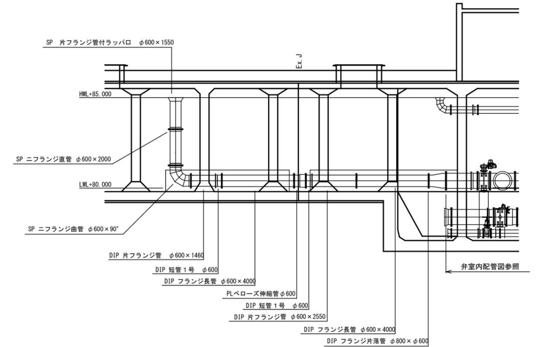
ダクタイル鑄鉄管 (DIP) は外面特殊塗装 (DD塗装) とする
