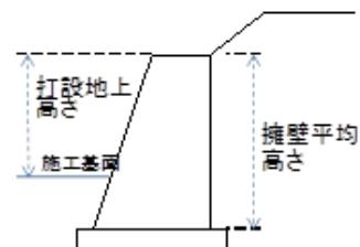
擁壁平均高さは、擁壁の前面勾配或いは背面勾配、天端幅、擁壁種類が同一の構造形式のブロックにて判断する
