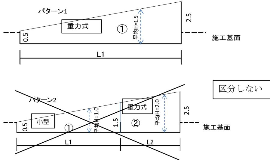
・L1 と L2 で区分せず、同一のブロックとし、擁壁平均高さを算出する。
