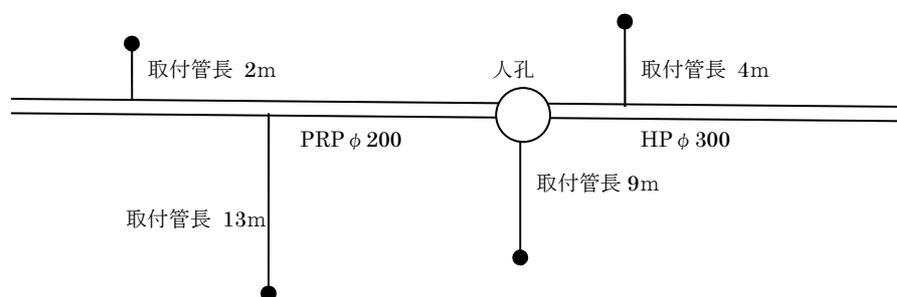
$$\text{取付管長： } (2\text{m} + 4\text{m} + 13\text{m} + 9\text{m}) \div 4 = 7\text{m}$$
