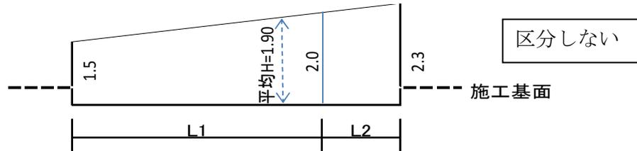
・L1 と L2 で区分せず、同一のブロックとし、擁壁平均高さを算出する。
