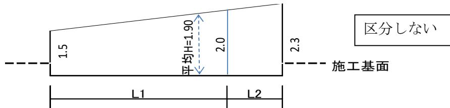
• L1 と L2 で区分せず、同一のブロックとし、擁壁平均高さを算出する。
