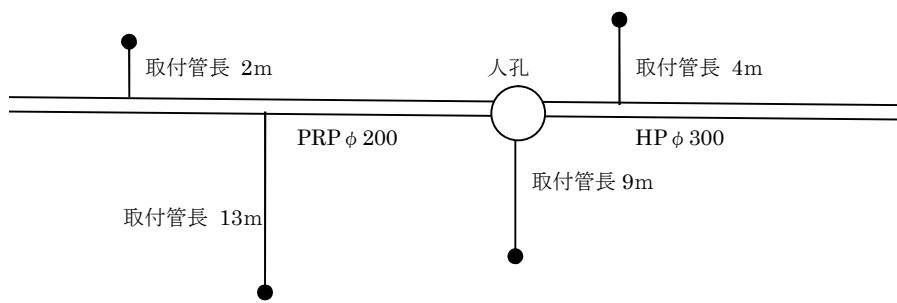
$$\text{取付管長 : } (2\text{m} + 4\text{m} + 13\text{m} + 9\text{m}) / 4 = 7\text{m}$$
