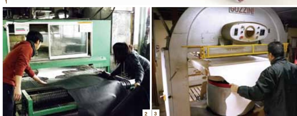
1.グラフィックレザーの技術を駆使した、様々な製品。2. ジェット噴射のラインに乗せて革を染色の様子。3.機械で型押しする様子。
