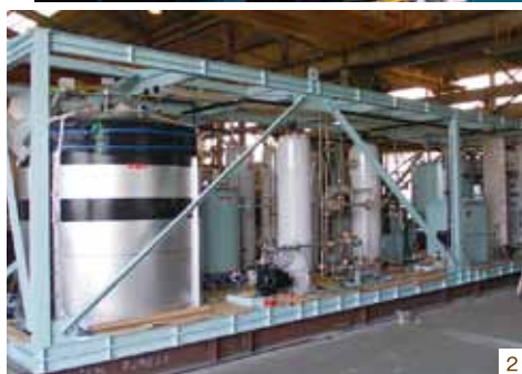
1.環境にも優しく安全性の高いTRP-Aim(ドロンバ)を使った濁水浄化前、浄化後。 2.ユニット型水処理装置で、有害金属やダイオキシン類の排水プラントとして集約。 3.コンパクトな全自動型の水処理装置で、水銀等難処理物質の処理を得意とする。
