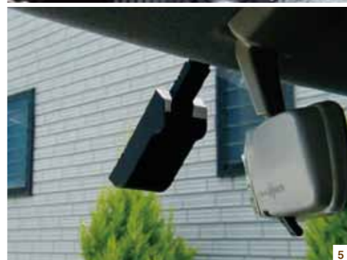
4.レインセンサーレイントロニック取付の様子。 5.走行中は雨量に応じて自動的にワイパーが作動。 6.現在新型レインセンサーを開発中。
