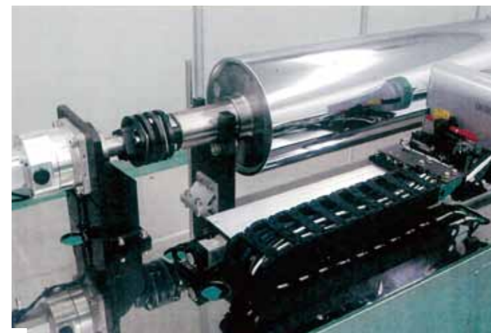
5.ミラーマイクロPは、数十μmの傷やピンホールを自動検出できる。
