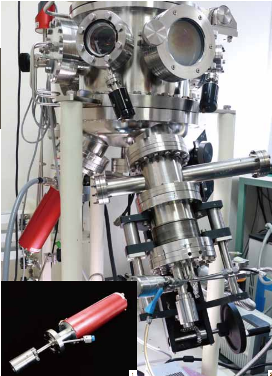
1. 超高真空1インチスパッタカソード。小型でありながら新機能化合物薄膜研究開発市場に貢献。 2. スパッタカソードを複数搭載した超高真空スパッタ装置酸化半導体、化合物薄膜電池材料開発等に応用。
