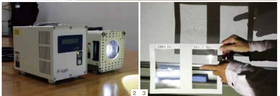
1.2.肉眼で見えなかった欠陥を容易に検出できる。 3.ラップに光を当てた比較欠陥検査の様子。
