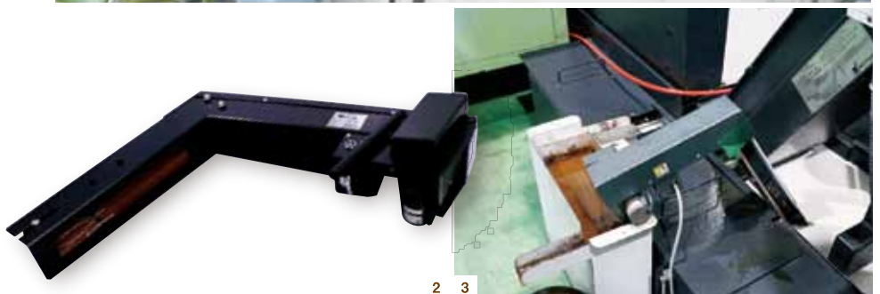
1.工場の機械1つひとつに、「愛称」が付けられ、機械に愛着を持って楽しく取り組める環境作りをしている。2.狭い場所でも容易に設置ができる。3.しぼりローラーの採用で、ベルトに吸着した水分をしぼり取るため、効率よく油・水の分離ができる。
