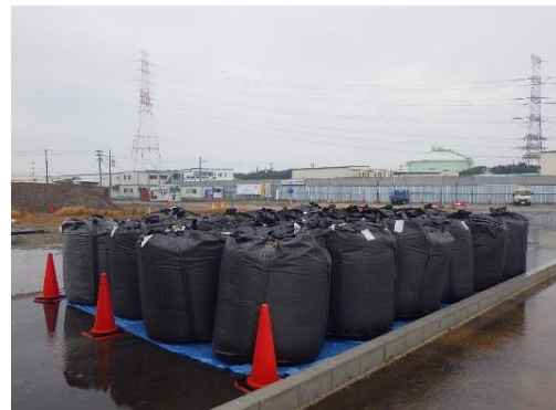
写真2 集塵機使用済み活性炭
