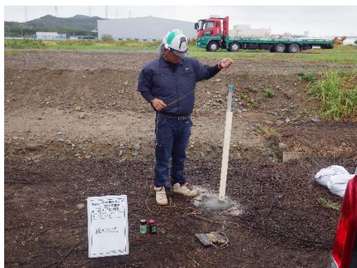
写真 2-14 地下水採水状況
