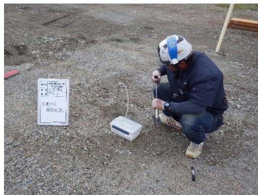
写真 2-15 土壤ガス採取状況
