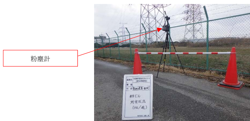
写真 2-7 粉塵量測定状況
