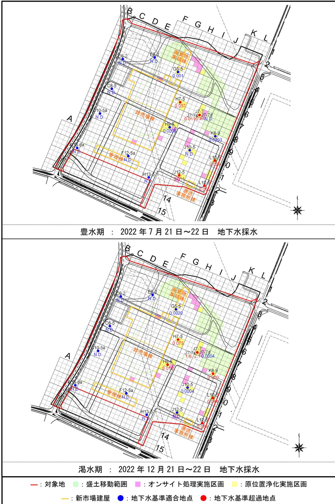
図 1.3.3 ベンゼン地下水濃度の検出状況（建設工事中の豊水期及び完了後の渇水期）
