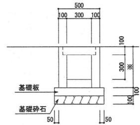
可変側溝300×300構造図 S:1/30
