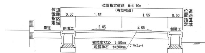
1号側溝工 現場打ち部分 (No. 1 Side Drainage Work Site Cast-in-place Part)
