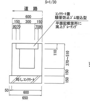
側溝工 可変側溝部分 (Side Drainage Work Variable Side Drainage Part)
