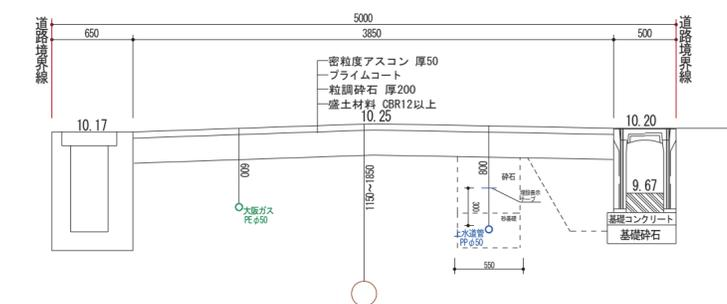
自由勾配側溝据付標準断面図 S=1/30
