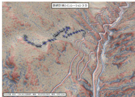
<レーザー計測成果を活用した作業道計画>
