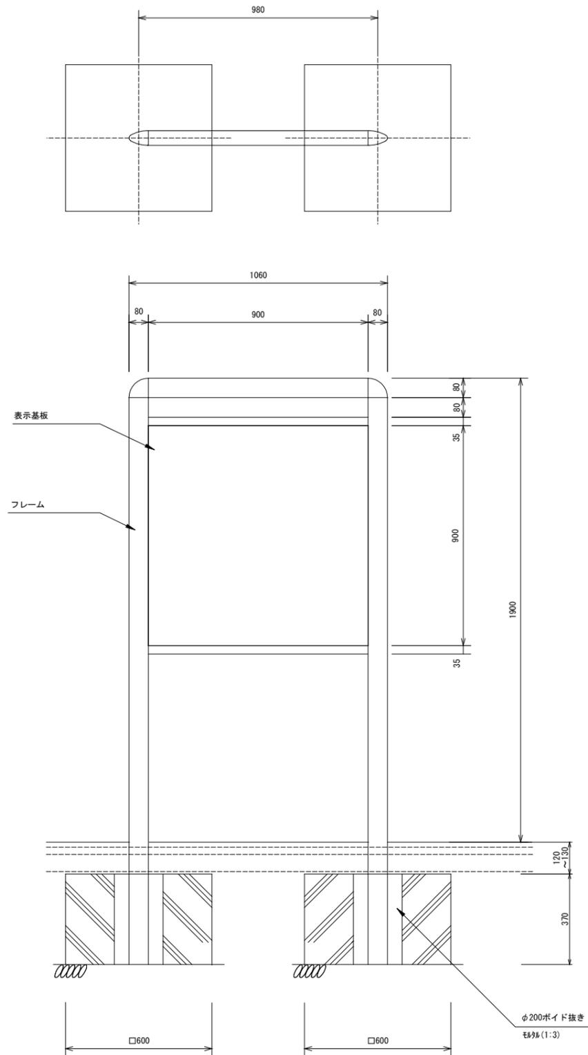
フレーム：アルミ押出材、合成樹脂焼付塗装（レッド）
