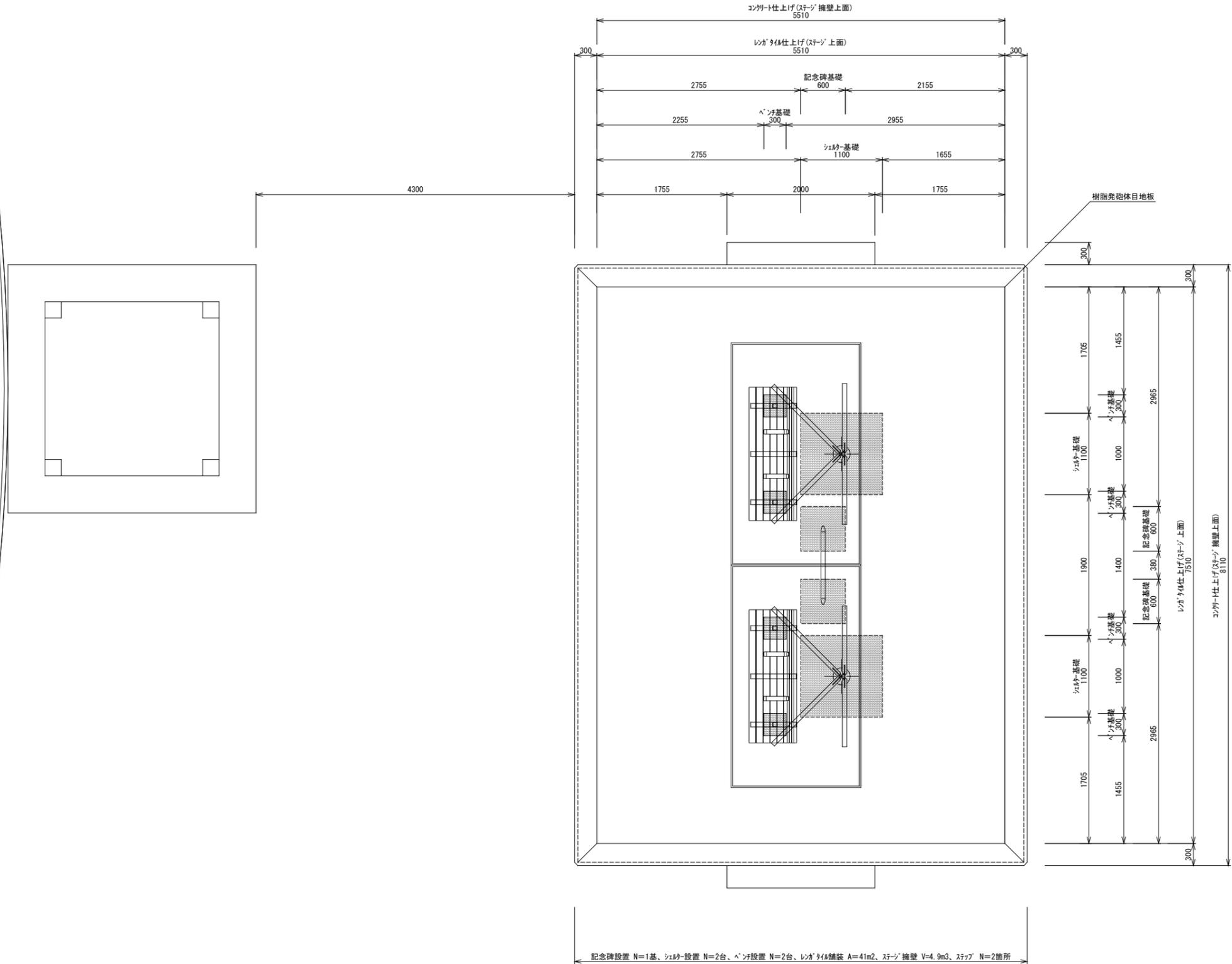
記念碑設置 N=1基、シヤク-設置 N=2台、ベンチ設置 N=2台、レガタイ舗装 A=41m2、ステージ擁壁 V=4.9m3、ステップ N=2箇所
