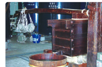
天秤棒に石を掛け、その圧力で新酒を搾り出す伝統手法「石掛け天秤搾り」
