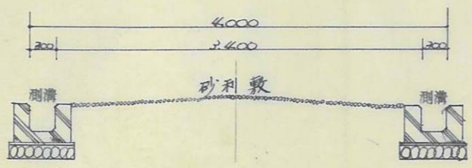
道路断面図 Scale 1:50
