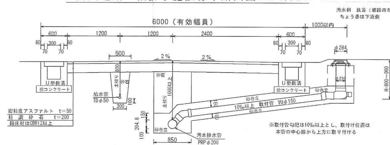
計画道路・給排水施設標準断面図 S=1/50
