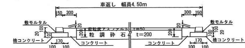
車返し L型側溝詳細図 1/50
