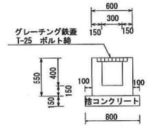
車返し L型側溝詳細図 1/50
