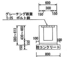
横断U型側溝②断面図 S=1/50
