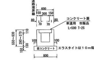
横断U型側溝①断面図 S=1/50
