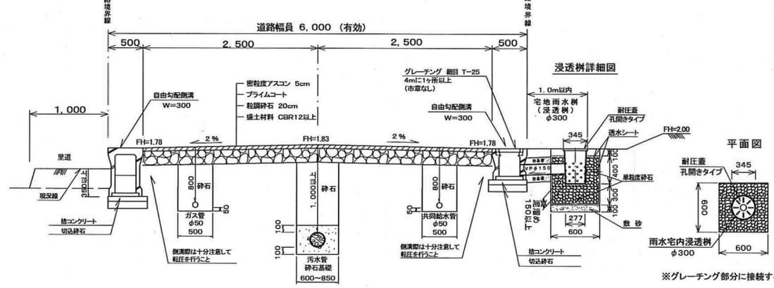
現場打側溝標準詳細図
